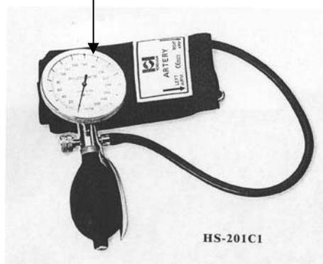
Slika 1: Fotografija tlakomjera za krvni tlak tip HS-201C1 s prikazom mjesta za smještaj ovjerne naljepnice
